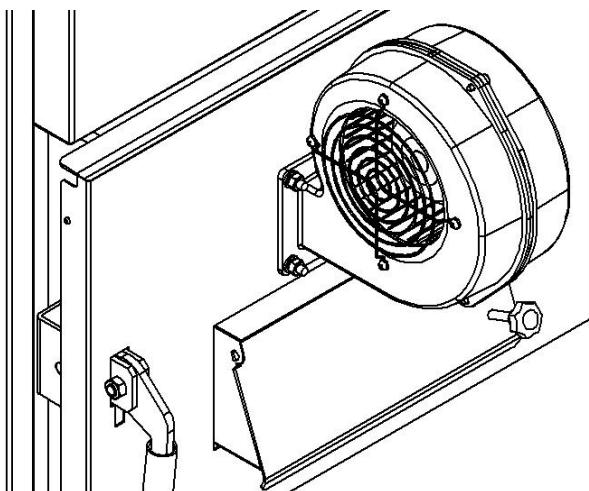
**Рис. 6 Установка вентилятора наддува**
