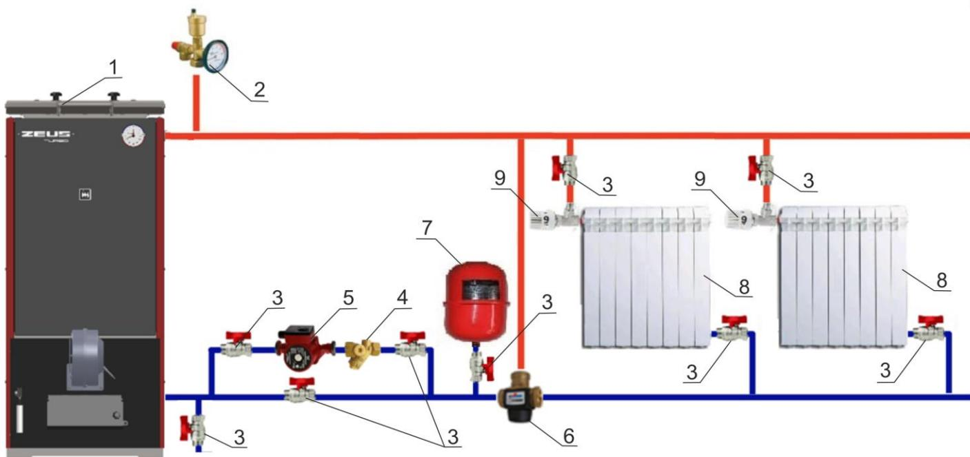
**Рис. 4 Схема подключения котла к закрытой системе с принудительной циркуляцией теплоносителя с терmostатическим смесительным клапаном**
