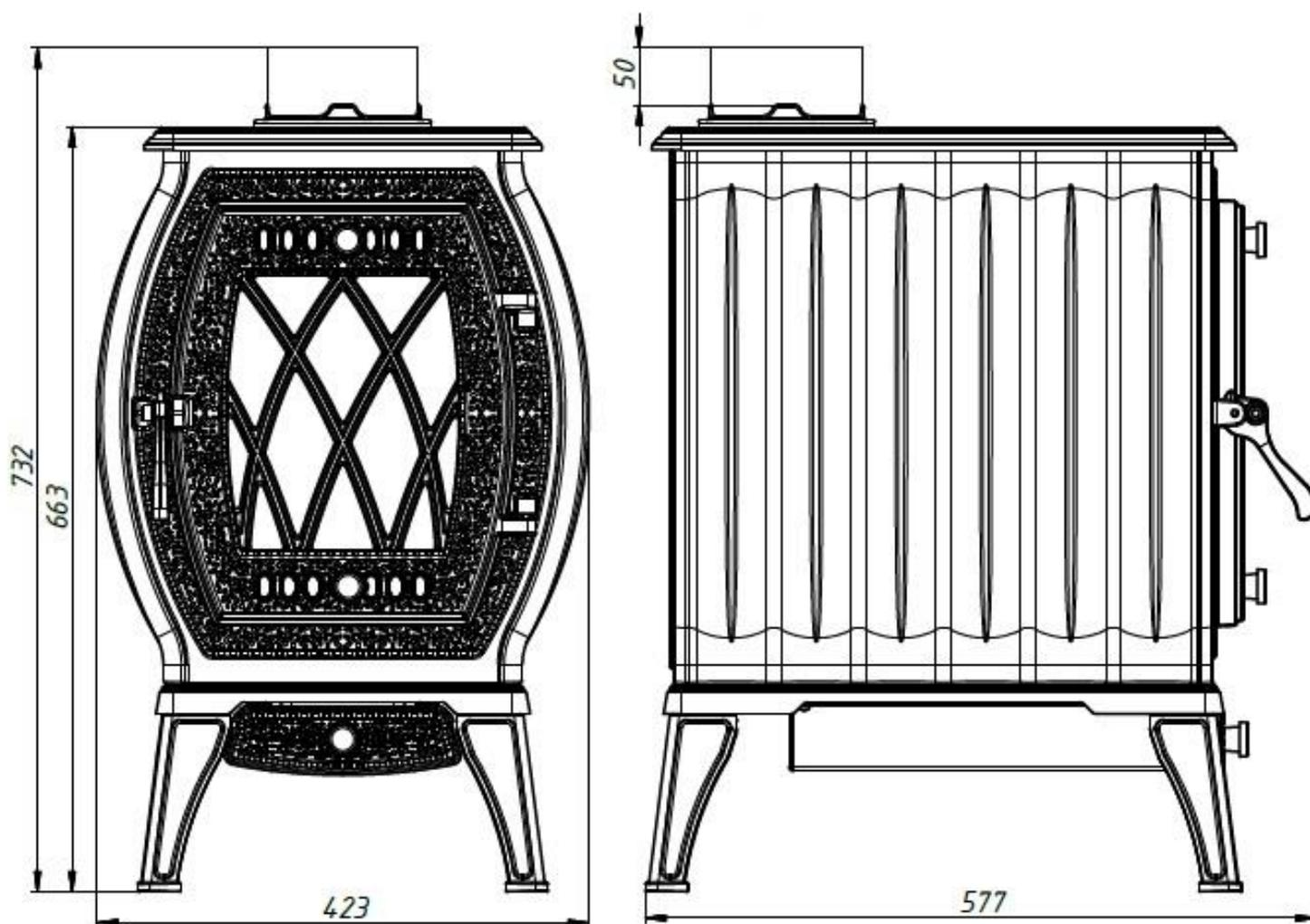
Рисунок 2. Габаритные размеры печи ПМЧ-10С
