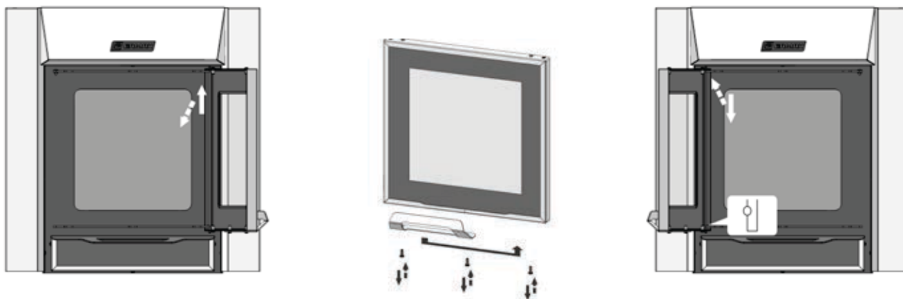
Рисунок - 6. Схема снятия и изменения открытия дверки
