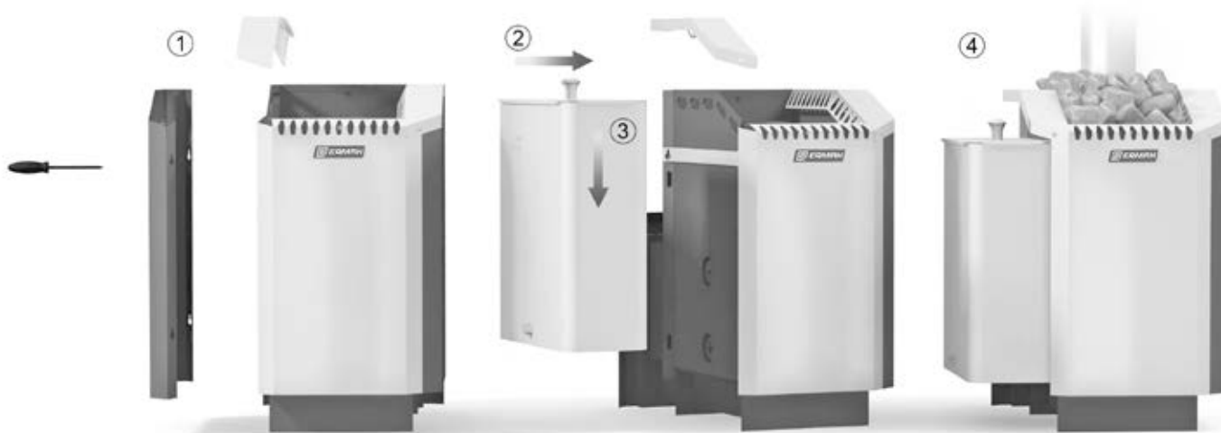
Рисунок - 9. Последовательность установки бака для нагрева воды
