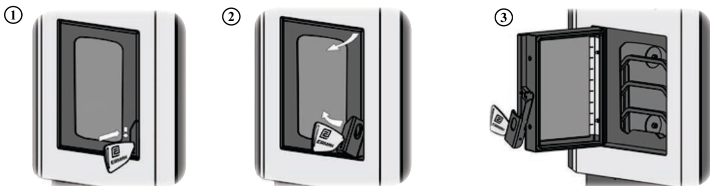
Рисунок - 13. Чистка стекла смотровой двери
