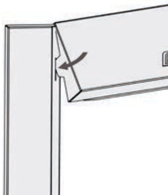
Рисунок - 5. Схема снятия и изменения открытия дверки
